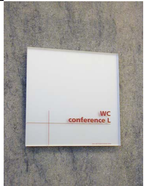
Abb. 2: Orientierungs-Schild aus 10 mm Glas , Oberfläche fein geätzt, Rückseite verspiegelt, Kanten Poliert, Beschriftung im Siebdruck nach Pantone
