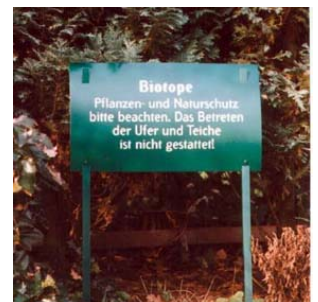
Abb. 3: Golfplatzschild bestehend aus 2 mm gebogenem Aluminium und 2 Erdspeisen aus 2 mm starkem Rechteckrohr; alle Teile grün pulverbeschichtet; Text im Siebdruck.
