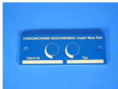
Abb. 2: Maschinenschild aus Edelstahl 1.4301 mit 240iger Korn geschliffen, vertieft geätzt und blau gelackt, Oberfläche schutz- lackiert und eingebrannt.
