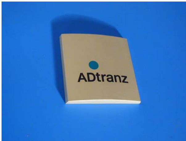
Abb. 2: Maschinenschild aus Edelstahl 1.4301 mit 240iger Korn geschliffen, vertieft geätzt und blau gelackt, Oberfläche schutz- lackiert und eingebrannt.
