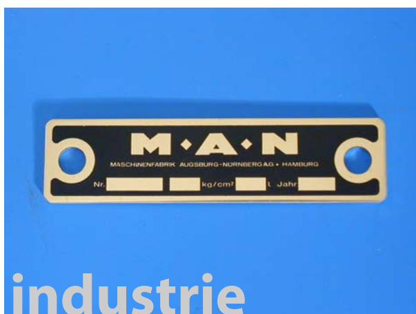
Abb. 5: Maschinenschild aus Edelstahl 1.4301 3D-Qualität; vertieft negativ geätzt, schwarz gelackt und ein- brennlackiert. Öl- und brennstoffbeständig.
